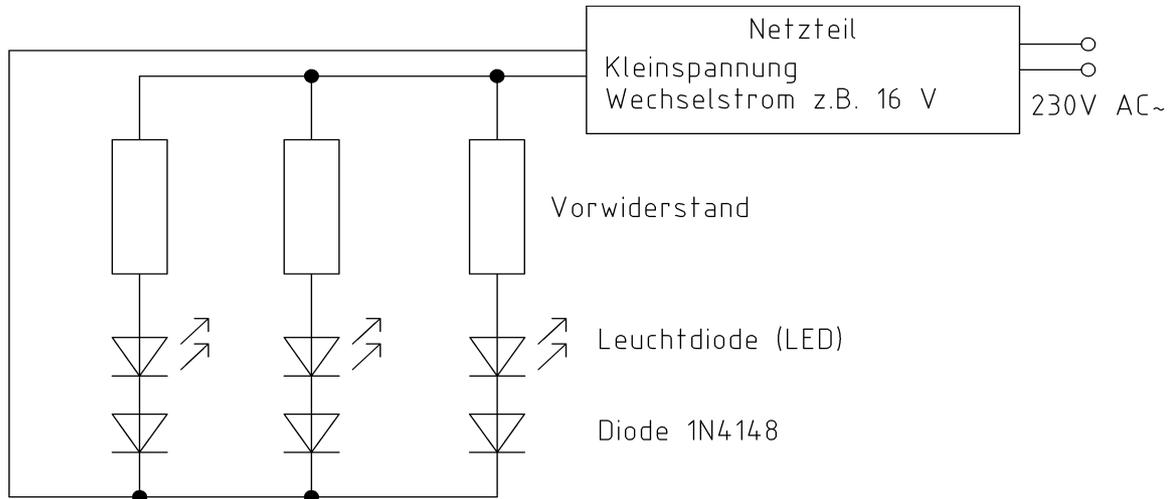
Dazu kann man eine Diode vor die LED schalten, z.B. eine 1N4148, siehe Schaltplan, die LED wird dann aber leicht flackern.
