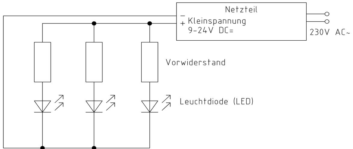
Jede einzelne LED darf mit maximal 20 mA (Milliampere) belastet werden.
